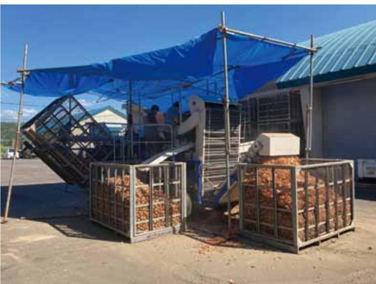
収穫した玉ねぎコンテナをJ Aで粗選別するため導入したタッピングセクター
